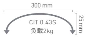
重复定位精度  $\pm 0.025\text{mm}$   $\pm 0.01\text{mm}$   $\pm 0.01^\circ$
