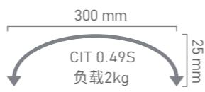
重复定位精度  $\pm 0.025\text{mm}$   $\pm 0.01\text{mm}$   $\pm 0.01^\circ$
